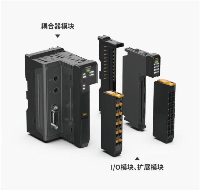
MIO REMOTE I/O 紧凑型远程 I/O 设备, 增强系统灵活性和效率 工业远程 I/O
